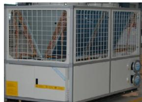
**Чиллеры с воздушным охлаждением, конденсатора с режимом теплового насоса (воздух-вода) со спиральными компрессорами. Капиллярное расширение фреона R407C**
