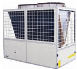
**Модульные чиллеры с воздушным охлаждением конденсатора с режимом теплового насоса (воздух-вода) со спиральными компрессорами. Капиллярное расширение фреона R407C**
